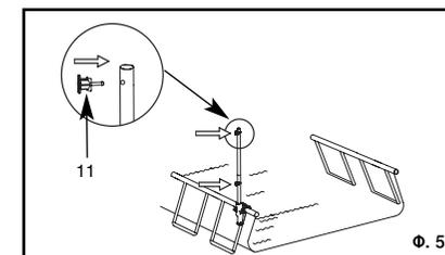
6. Таким же образом установите вторую опору с противоположной стороны, повторив п.2 и 5.
