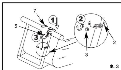
4. Установите собранную опору в крепеж (7). Закрепите опору длинным болтом (1). С помощью регулирующих болтов закрепите опору вертикально. **ВНИМАНИЕ:** Регулировать наклон опоры можно с помощью болтов (1). Не закручивайте болты туго и не используйте для этого плоскогубцы.
