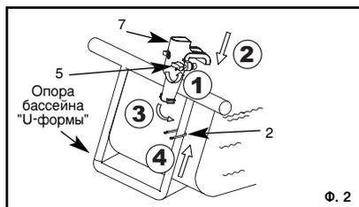
3. Закрепите крепеж болтом и гайками. Крепеж в виде лапки закручивайте по часовой стрелке руками. **ВНИМАНИЕ:** Не следует закручивать болты слишком туго; для закручивания не используйте плоскогубцы.
